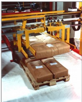
Packlage wird von Hubeinheit auf Palette abgesetzt.
