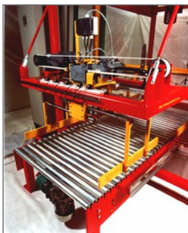
Grundstellung der Positioniereinheit. Packstück kann zugeführt werden.
