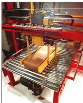
Positioniereinheit umgreift Sackware zum Ausrichten und Drehen.
